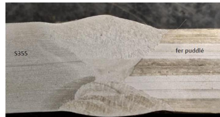
La soudure pourra être utilisée lors de la restauration du pont (en complément du rivetage à chaud).
